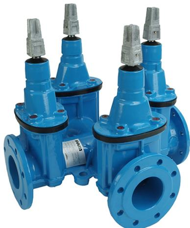
Les ensembles robinets-vannes Type 4 sont des appareils de sectionnement à opercule surmoulé d'élastomère de DN80 à 200 PFA16 destinés à être utilisés en position tout ou rien.
