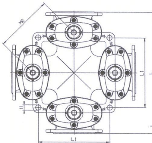
Les 4 corps de l'ensemble RVOC Type 4 ont le même diamètre. Les cotes d'encombrement sont donc toutes symétriques par rapport à l'axe central.
